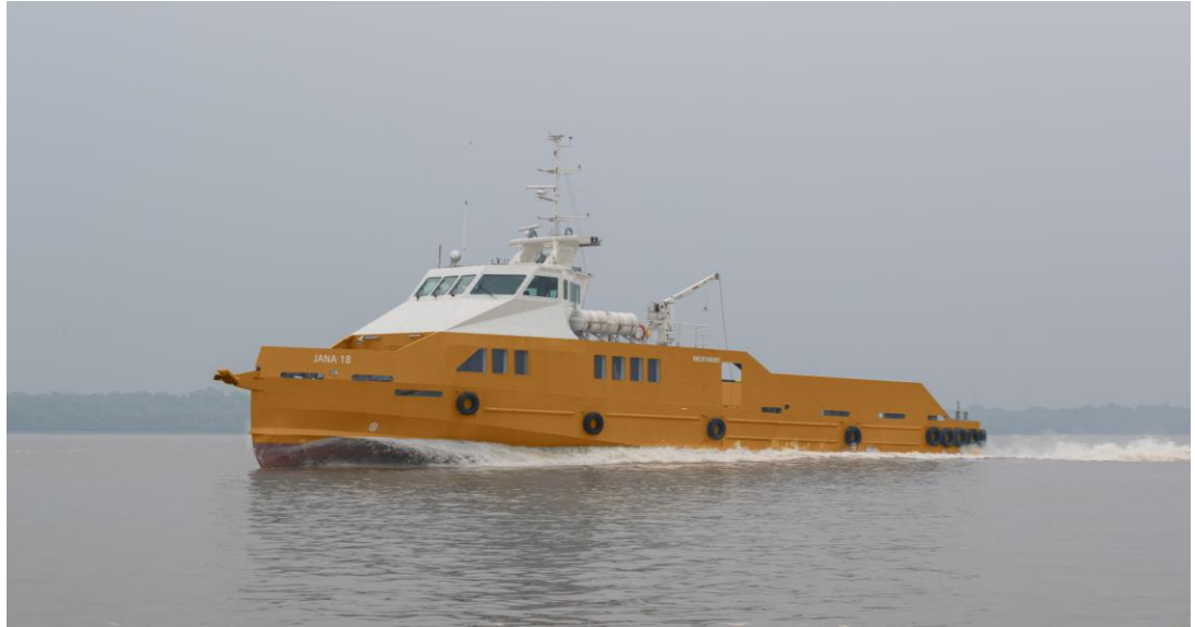
FPSV 41P: Fast Personnel and Supply Vessel 41 m / hélices à pas fixes
